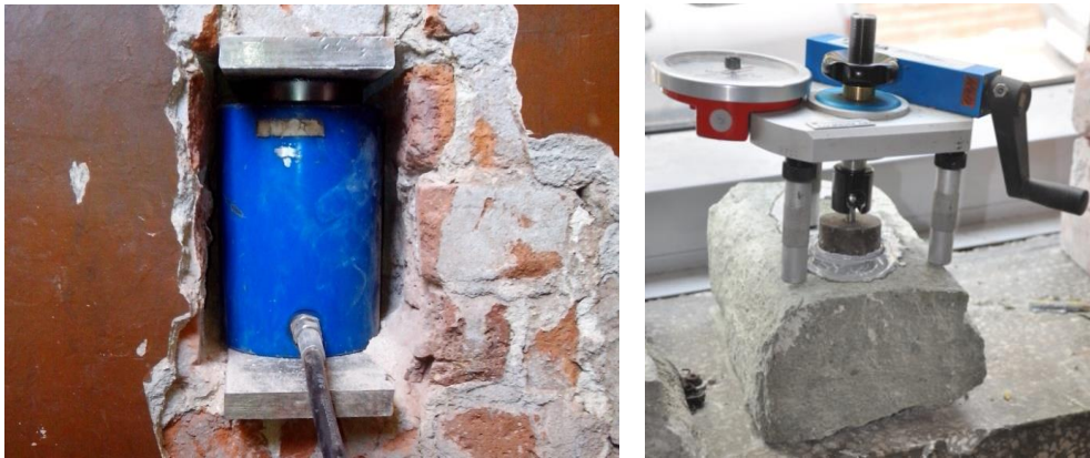
Фиг. 4. Полево определяне на якостта на натиск на тухлената зидария и лабораторно определяне на адхезия на каменната зидария
