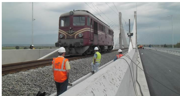
Фиг. 6а, б и в. Приемателно динамично натурно изпитване на Дунав мост 2
