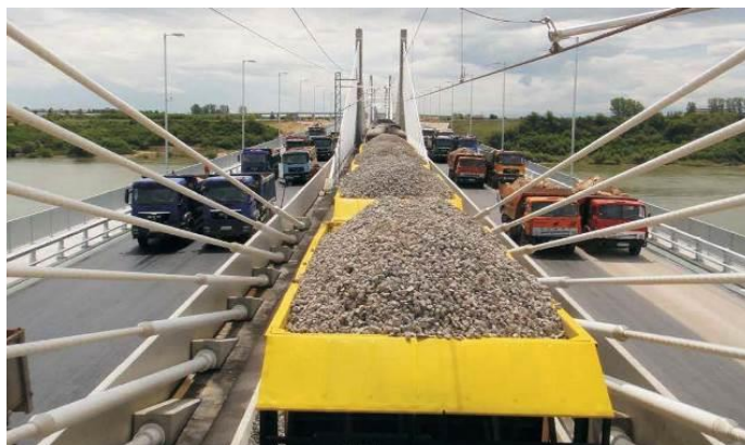
Фиг. 5а. Приемателно статично натурно изпитване на Дунав мост 2
