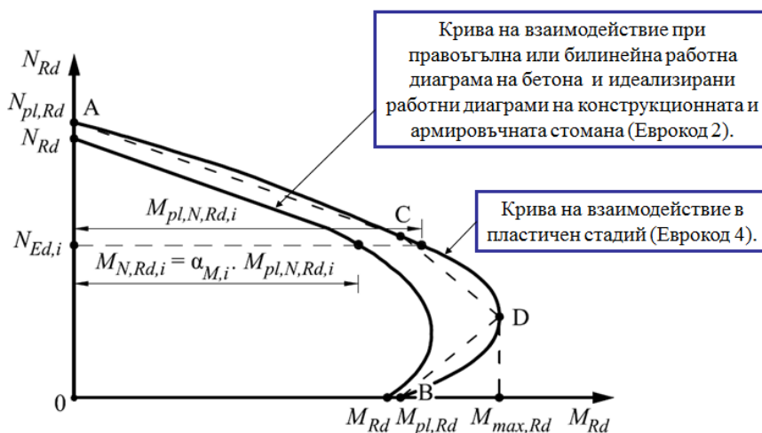
Фиг. 2. Определяне на носимоспособността на огъване M_{N,Rd,i} при правоъгълна или билинейна работна диаграма на бетона съгласно БДС EN 1992-1-1:2005 [1] и на носимоспособността на огъване M_{pl,N,Rd,i} в пластичен стадий съгласно БДС EN 1994-1-1:2005 [2]
