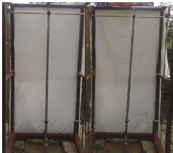
Фиг. 4. Експериментално определяне на собствена кръгова честота на стендов модел
