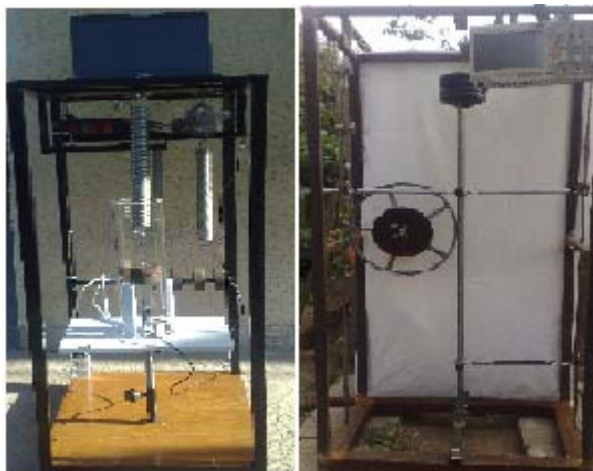
Фиг. 1. Стенд за изследване праволинейните трептения на материална точка и стенд за на изследване ъгловите трептения на тяло във вертикалната равнина – общ изглед
