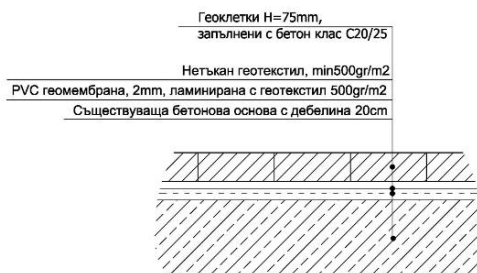
Фиг. 1. Вариант IV – Типов детайл за облицовка на дъно
