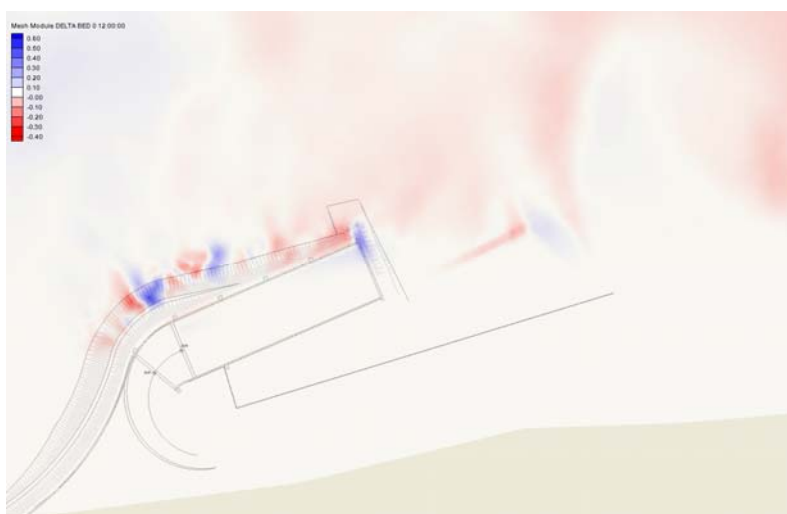
Фиг. 4. Зони на изравняне и отлагане на наноси в района на ФК “Никопол” при протичане на Q_{\text{ср.макс.}} = 10\,300 \text{ m}^3/\text{s}
